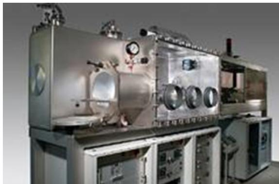
Рис. 2.2. Внешний вид установки жидкофазной эпитаксии для выращивания пленок полупроводниковых твердых растворов
