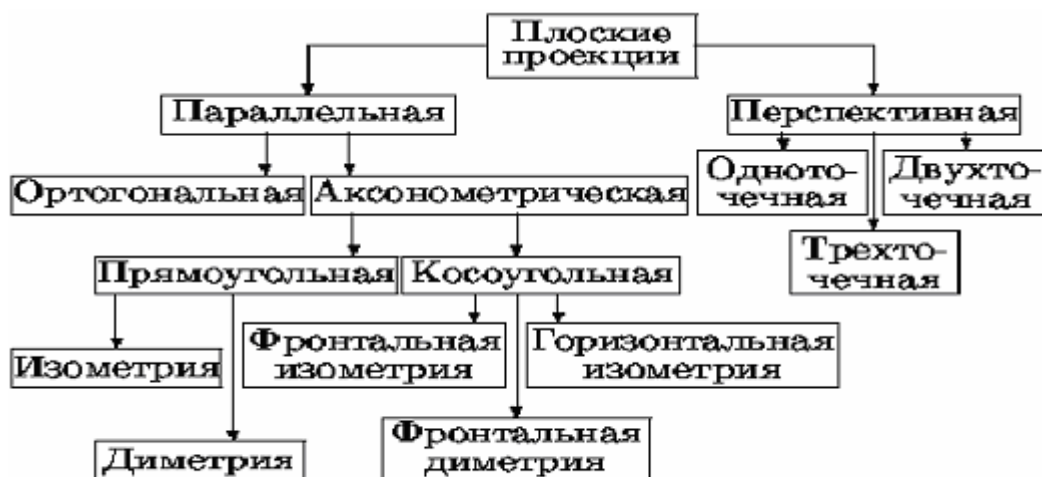
Рис. 1.3. Классификация плоских проекций
