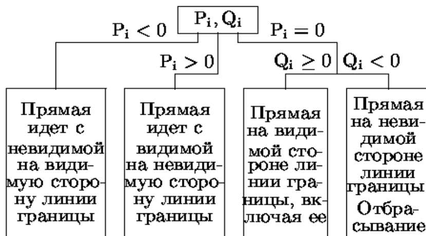
Рис. 5.8. Блок-схема алгоритма Лианга-Барски
