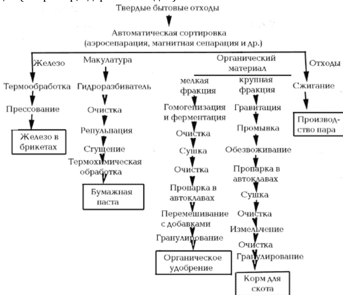
Рис.22. Принципиальная схема промышленной переработки отходов по технологии компании «Сорайн Чеккини» (Италия)
