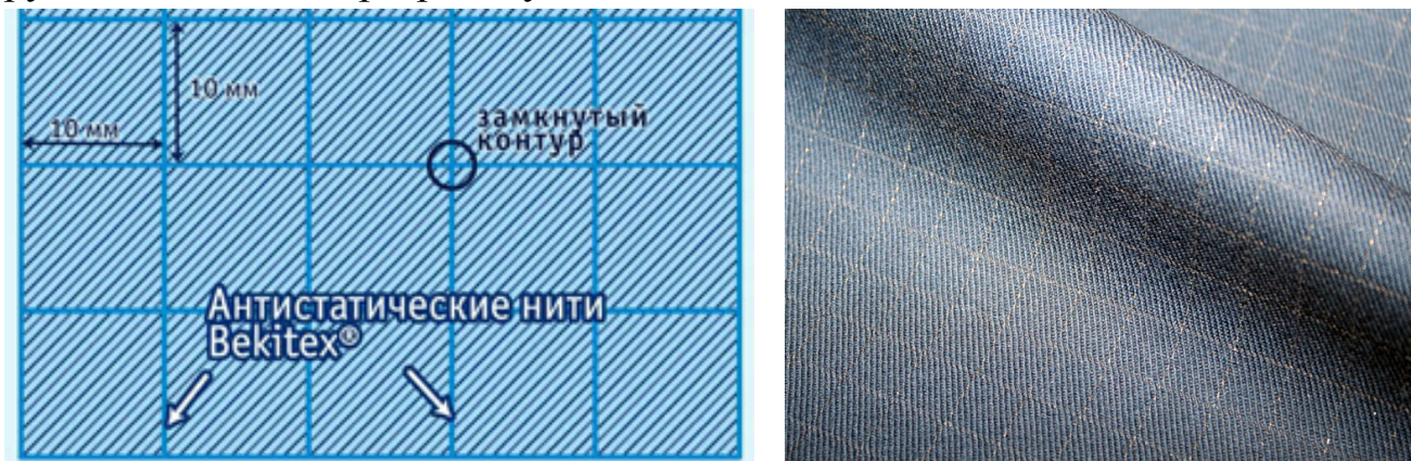
Рис. 1. Схема и внешний вид ткани со встроенными антиэлектростатическими нитями
