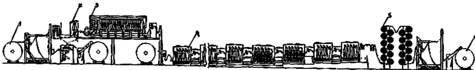
Рис. 3.38. Красильная линия фирмы «Кюстерс» с использованием устройства «Флекснип»:
