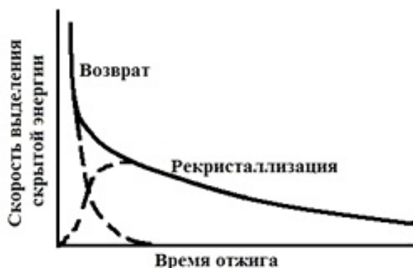
Рис.1.9. Схема наложения процессов возврата и рекристаллизации в процессе термообработки [86]
