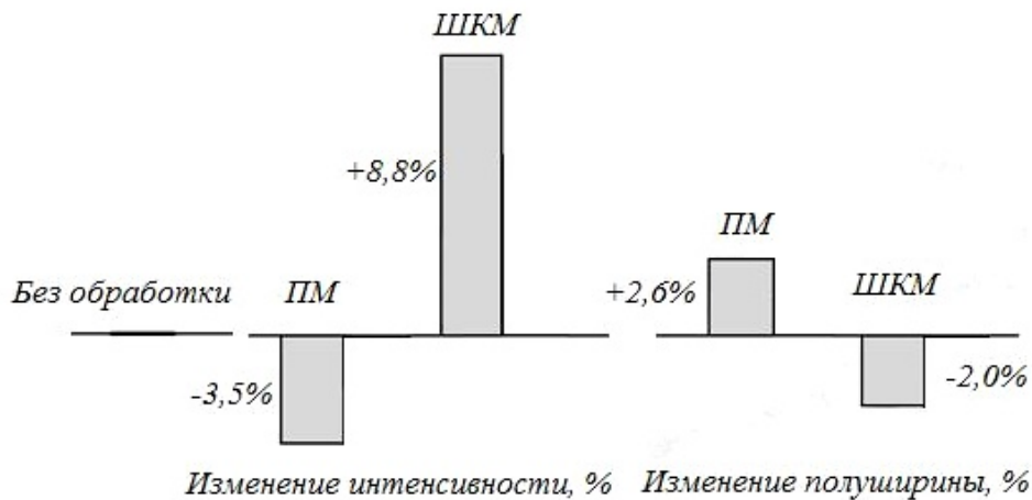
Рис. 3.25. Изменение интенсивности и полуширины ( b_{1/2} ) главных дифракционных рефлексов MgO, %
