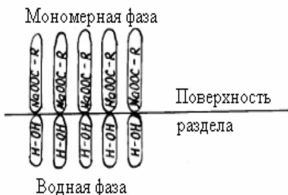
**Рис.9.** Ориентация молекул мыла (эмульгатора) на поверхности раздела фаз
