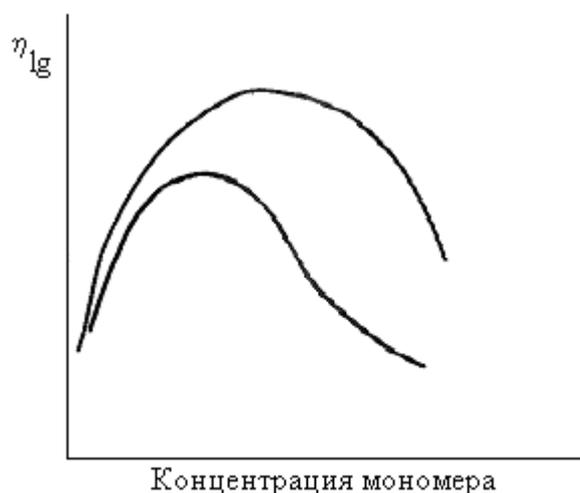
**Рис.15.** Зависимость логарифмической вязкости полимера от концентрации мономеров
