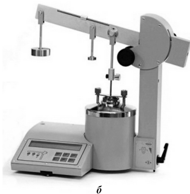
Рис. 20. Шариковый вискозиметр Гепплера: а - с падающим шариком; б - с надавливающим шариком
