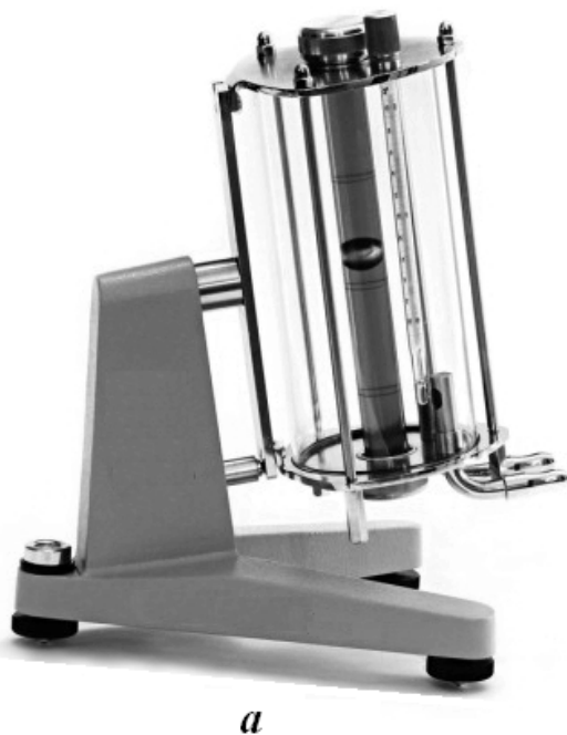
Рис. 20. Шариковый вискозиметр Гепплера: а - с падающим шариком; б - с надавливающим шариком
