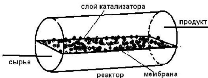
Рис.1. Схема работы ПМК с нанесенным слоем катализатора
