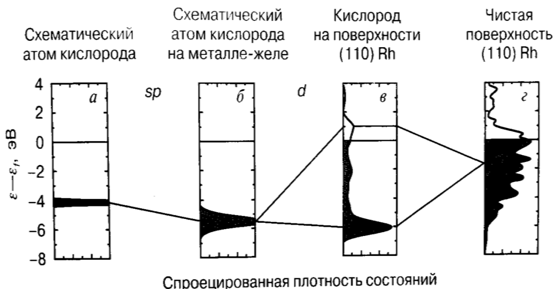
Рис. 4. Схематическая иллюстрация изменения локальной электронной структуры атома кислорода, адсорбированного на поверхности переходного металла родия, плотность состояния которого показана на правом крайнем рисунке. Гибридизация 2p -орбиталей кислорода с sp -зоной переходного металла определена для идеализированной модели металла. Результат гибридизации – сдвиг вниз и уширение 2p -уровня. Гибридизация орбиталей этого уровня и орбиталей d -зоны родия приводит к плотности состояний хемсорбированного атома, в которых связывающая и разрыхляющая орбитали разделены [21]
