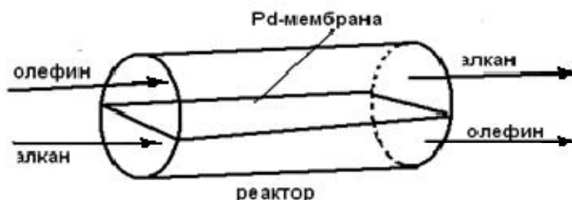
Рис.2. Сопряжение реакций на ММК
