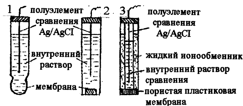
Рис. 10. Конструкции различных типов электродов: 1 – стеклянный электрод; 2 – твердый мембранный электрод; 3 – жидкостной мембранный электрод
