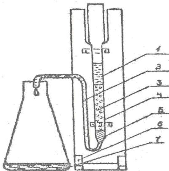
Рис. 3. Устройство висмутового редуктора:
