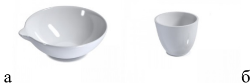
Рис. 7. Фарфоровая посуда: а- чашка для выпаривания; б- тигель.
