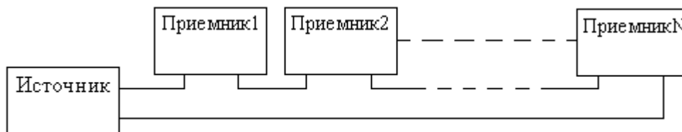
Рис. 1.3. Передача токового сигнала к нескольким приемникам.
