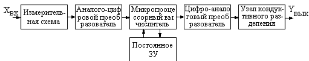
Рис. 1.7. Унифицирующий преобразователь на базе микропроцессорного контроллера.
